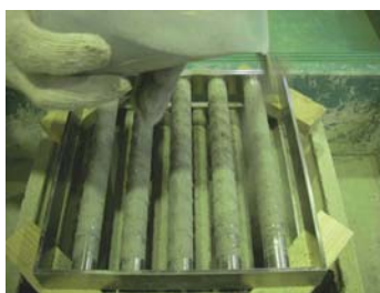
(a) 格子型マグネットによる磁力選別
