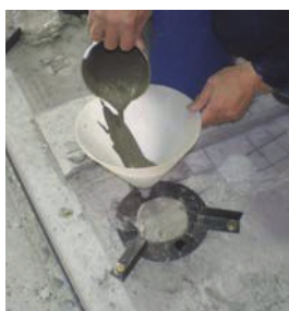
写真-1 グラウト充填状況
