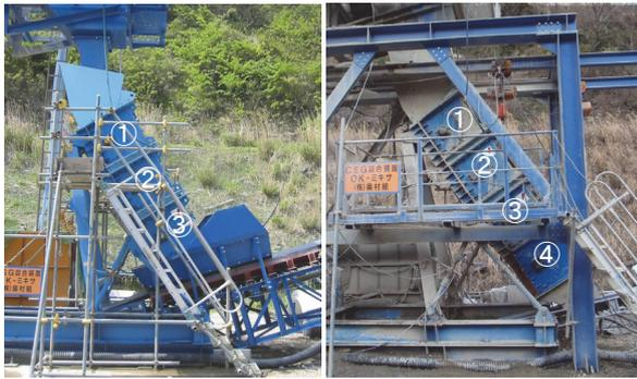
写真-16 3連式および4連式混合装置
