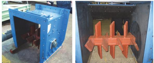
写真-4 ボックス構造 写真-5 パドルの形状
