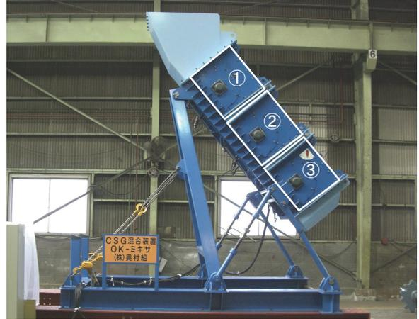
写真-3 3連式混合装置
