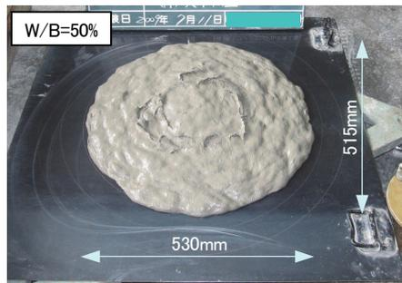
写真-2 スランプフロー試験状況例
