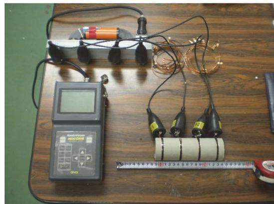
写真-1 改良地盤の比抵抗測定状況
