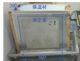
写真-2 小型試験体の形状
