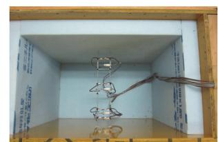
写真-3 埋込み型ひずみゲージと熱電対
