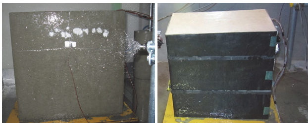
写真-1 養生状況 a) 散水養生 b) 湿布養生
