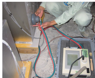
写真-3 表面透気試験状況
