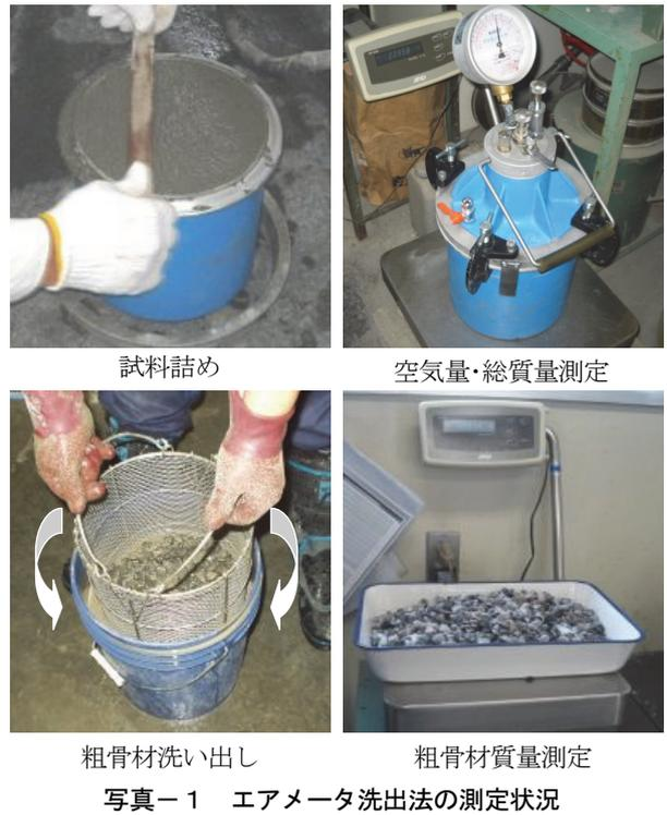
写真-1 エアメータ洗出法の測定状況
