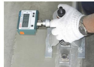
写真-5 付着性試験状況
