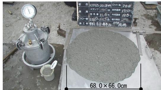
写真-1 フレッシュコンクリートの性状 (受入れ試験状況)
