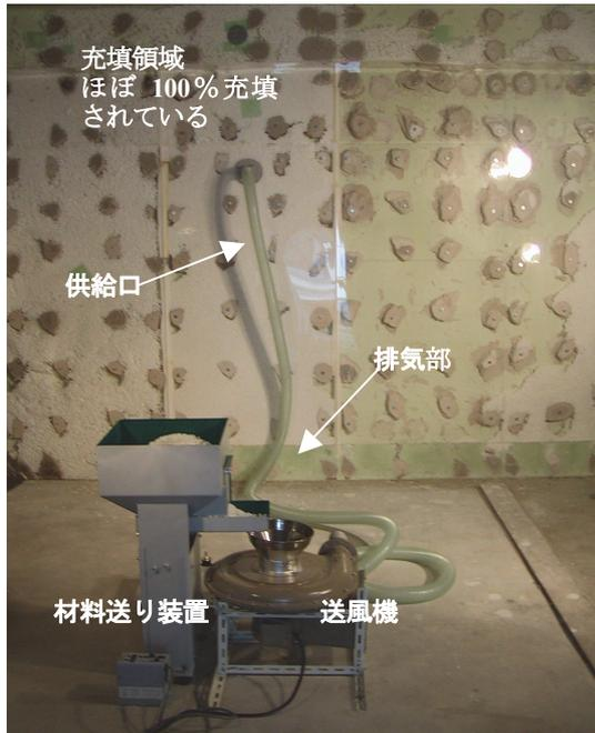
写真-4 吹き込み装置と試験状況
