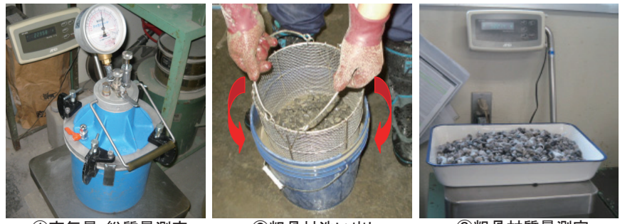
①空気量・総質量測定 ②粗骨材洗い出し ③粗骨材質量測定
