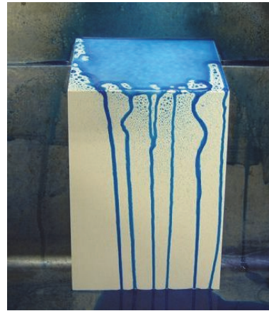
写真-7 雨筋汚れ発生再現実験
