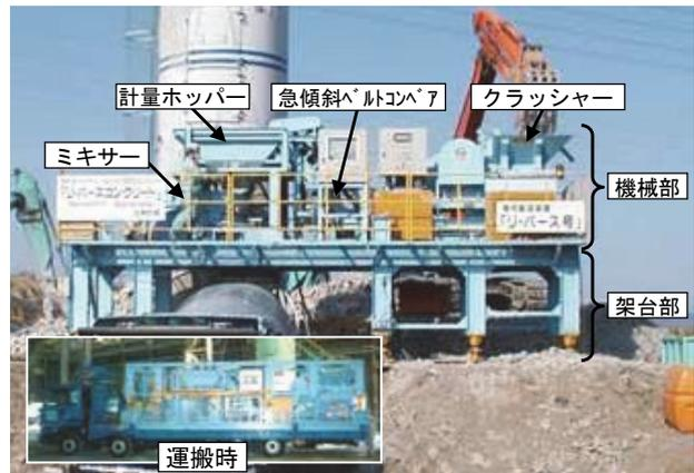
写真-1 製造装置「リ・バース号」
