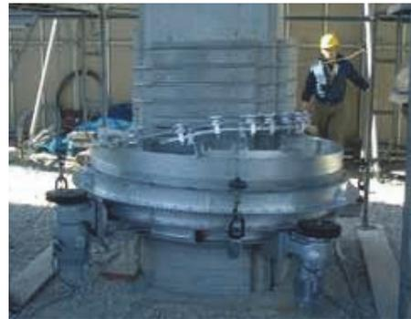
写真-1 スパイラル鋼線自動巻付機
