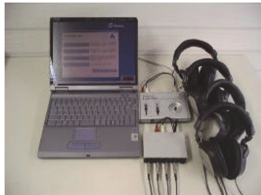
写真-1 遮音性能評価システム
