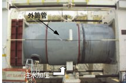
写真-5 外圧負荷実験状況
