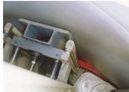
写真-1 新設防水シート固定装置
