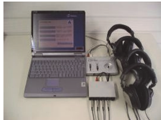
写真-1 遮音性能評価システム
