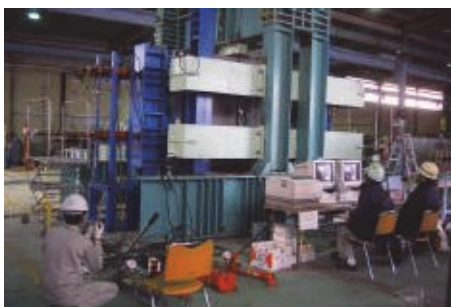
写真-3 継手曲げ試験状況
