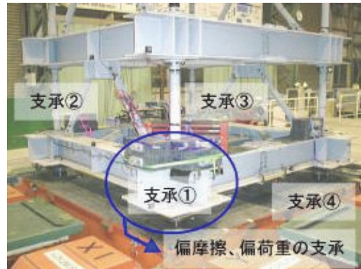
写真-1 付加質量の設置状況 ～ 偏荷重時 ～
