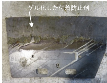
⑤引抜き後の目地板
