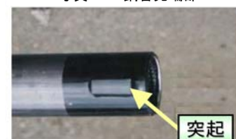
写真-3 鋼管後端部
