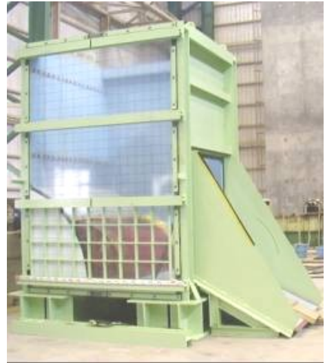
間詰め材充填土槽実験装置
