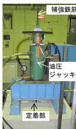
引き抜き試験状況
