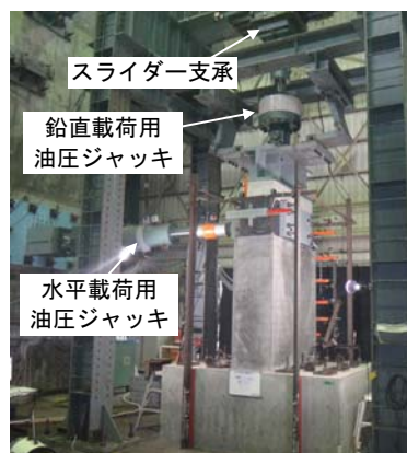
正負交番載荷試験状況
