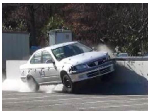
車両衝突試験状況(条件B)
