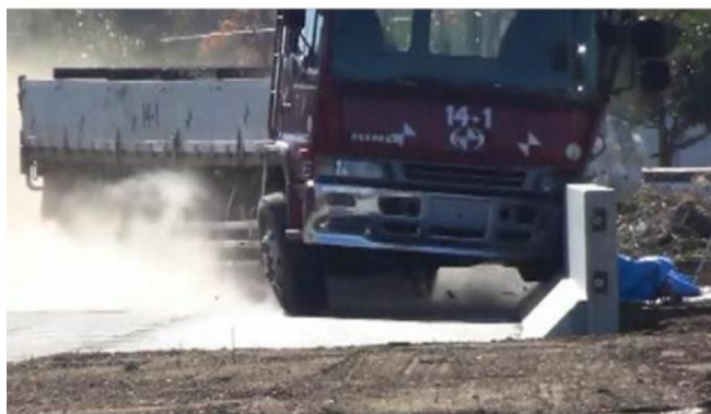
車両衝突試験状況(条件A)
