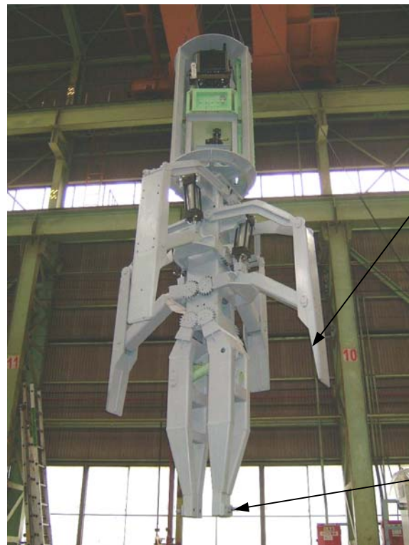
写真-1 レンガ解体機全景
