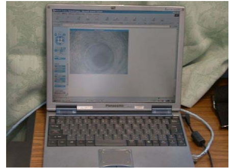
写真-2 無線 LAN 伝送により映し出された煙突内部
