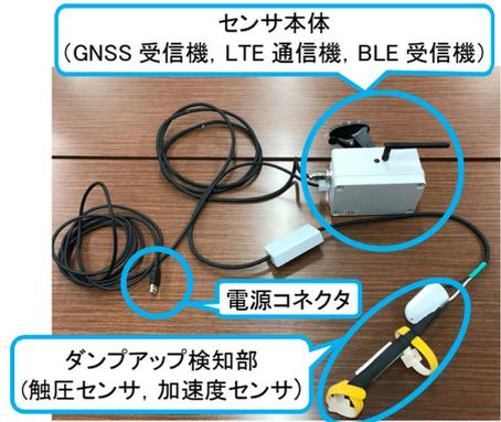
写真-1 ダンプアップ検知センサ
