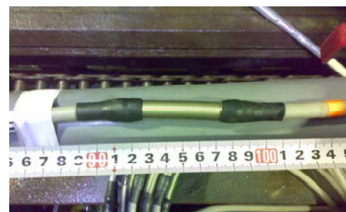
写真-1 地中に埋設する電極
