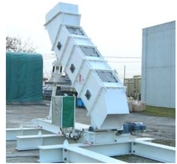
写真-2 混合装置
