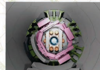
エレクターでセグメントの組立を行います。
