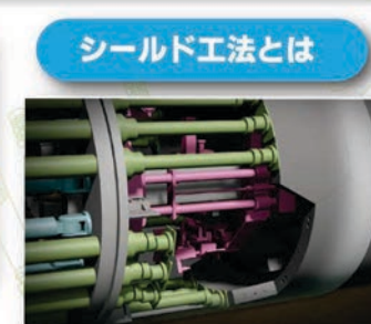
1.5m掘進するとシールドジャッキを縮めてセグメントの挿入スペースを作ります。
