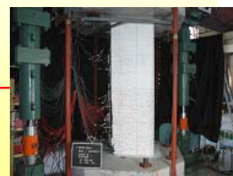
コア耐震壁工法 (加力実験の様子)
