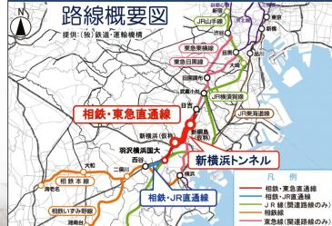
相鉄・東急直通線「新横浜トンネル」工事は、泥水式シールド工法で新横浜駅（仮称）から差進し新横浜駅（仮称）に到達するまでの延長3.304㍍、セグメント外径9.5㍍の複線断面のトンネルを新設するものです。
