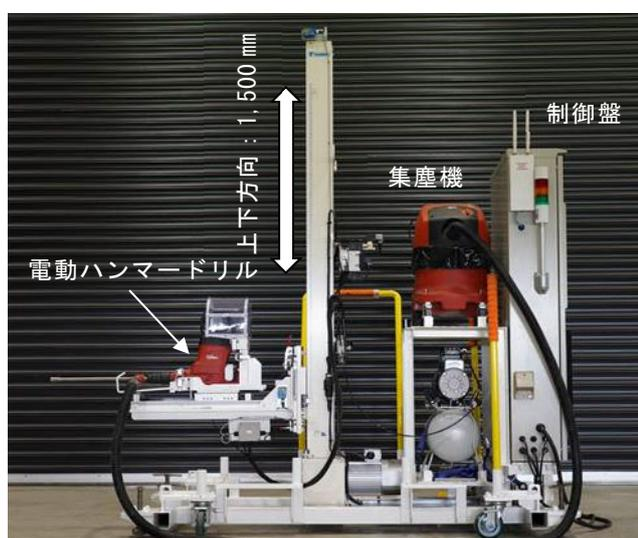
写真-2 小径用自動削孔装置
