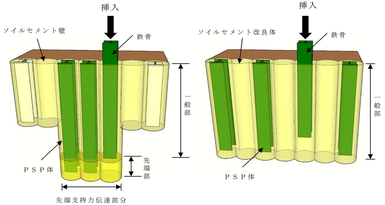
(1) 押し込み荷重を支持する場合の例 (2) 引抜き荷重にのみ抵抗させる場合の例
