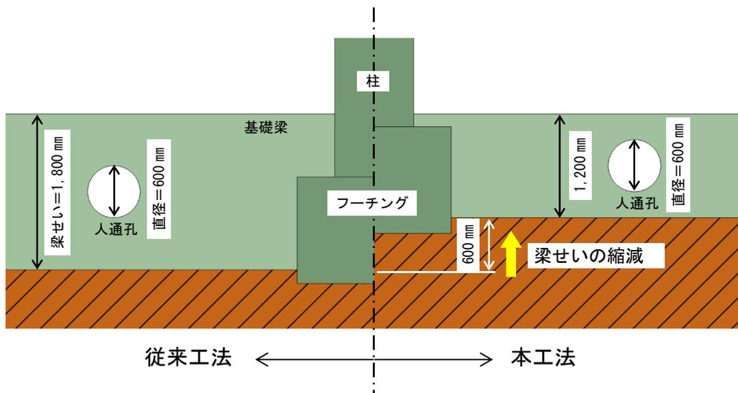
図-2 本工法と従来工法との比較
