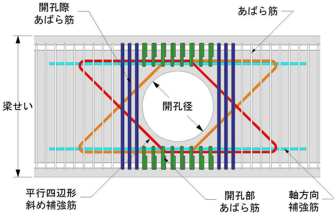
図-1 本工法による開孔補強の概要
