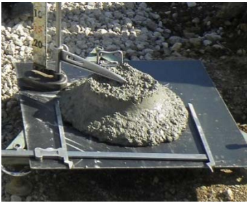
普通コンクリート (スランプフロ- 37cm)
