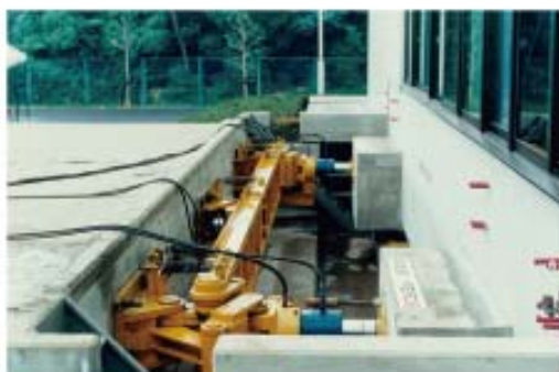
自由振動実験装置 (200 トンジャッキ・2 基)
