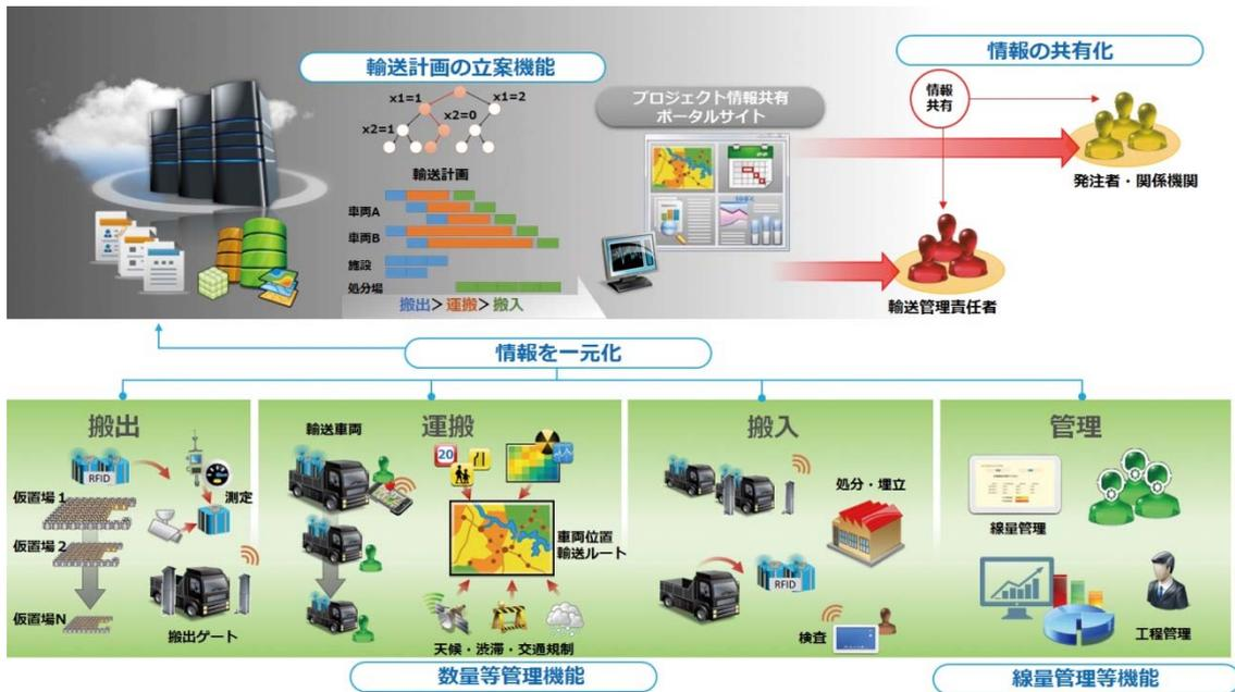
図-1：輸送統合管理システムの概念図
