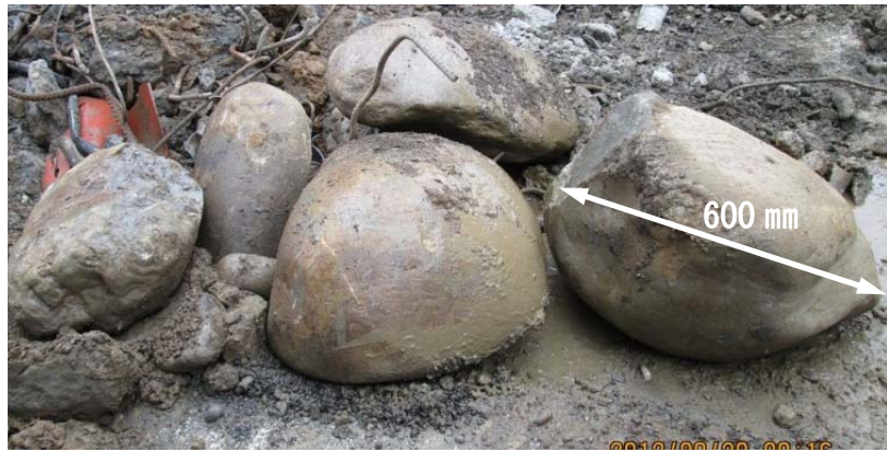
写真-1 礫層からの排土に含まれていた巨礫
