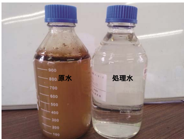
写真-3 事例②における処理状況
