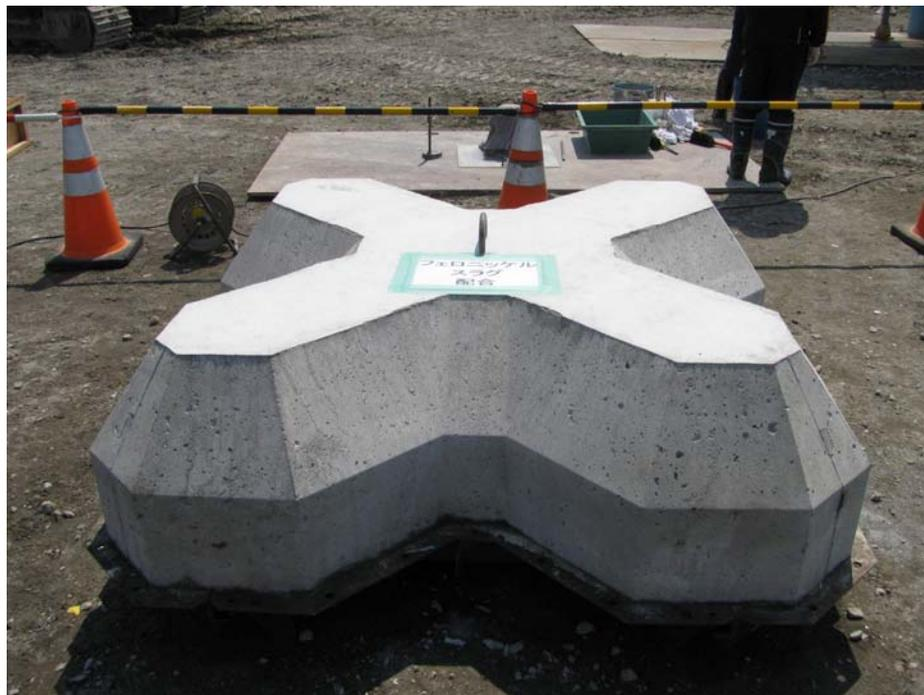
写真5 製作した被覆ブロック
