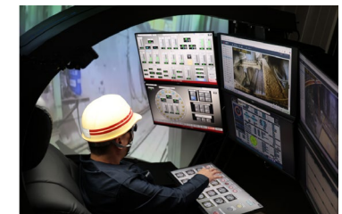
（シールドマシン遠隔操作状況）
