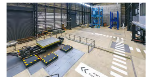
耐震実験棟 (手前が振動台)
